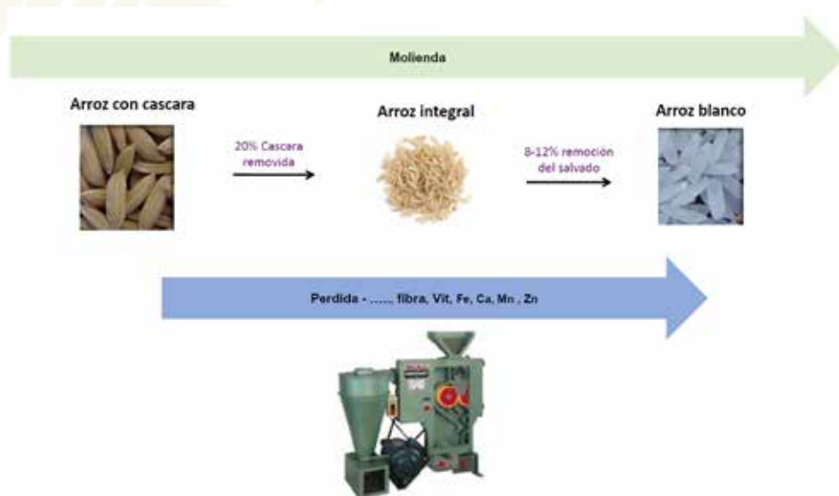
Figura 3. Pérdidas del contenido de zinc en el proceso de molinería en el grano de arroz.
