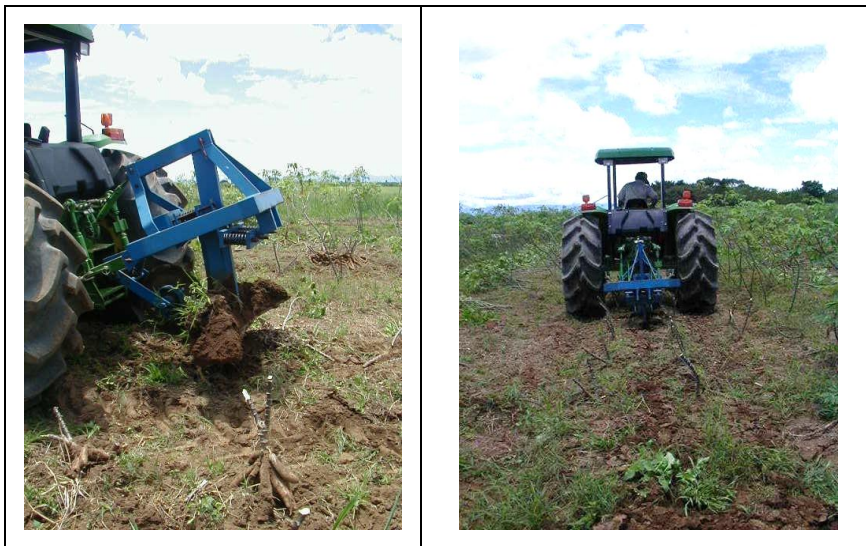
Figura 7-13. Implemento flexible para cosechar yuca, cuando entra en el suelo.
