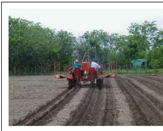
Figura 7-8. Implemento de dos líneas para plantar estacas de yuca. Su nombre comercial es Planticenter PC20.
