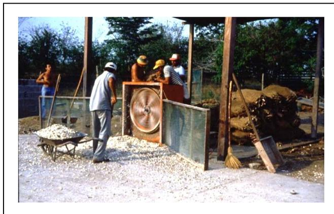
Figura 5. Máquina picadora de yuca con disco de tipo tailandés.
