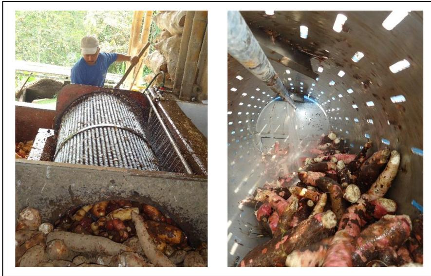
Figura 4. Máquina lavadora de yuca con tambor cilíndrico rotatorio.
