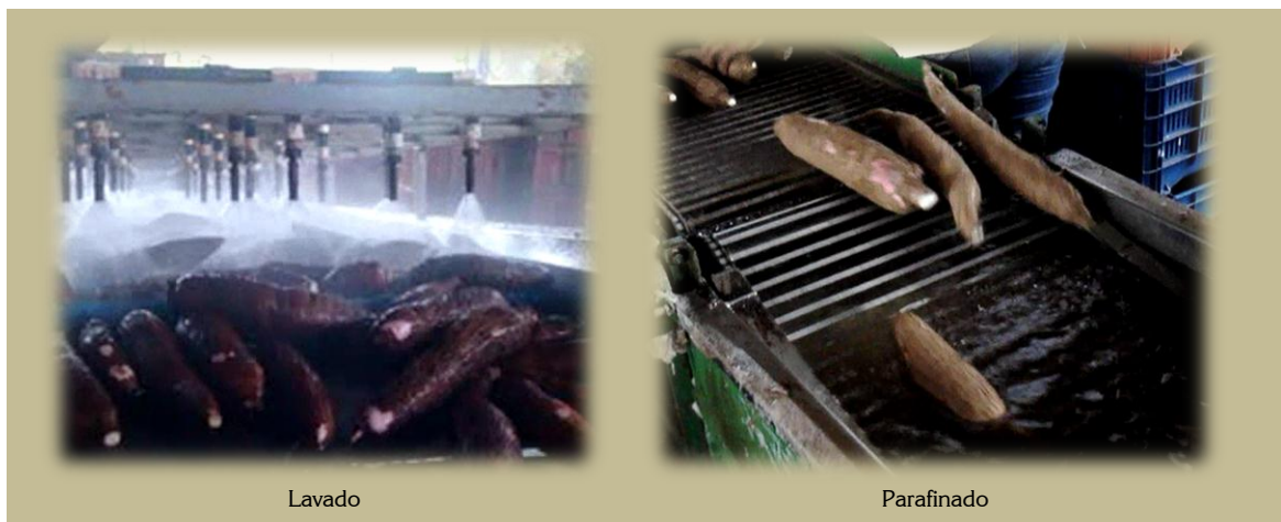
Figura 14. Etapas mecanizadas para el parafinado de yuca.
